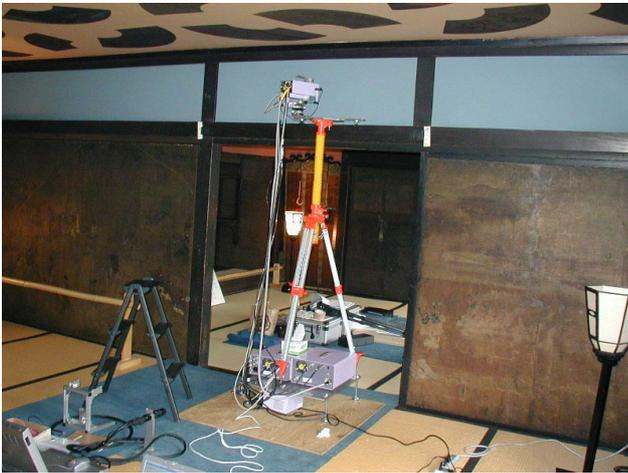
図5 土壁の測定現場写真（京都府角屋）
